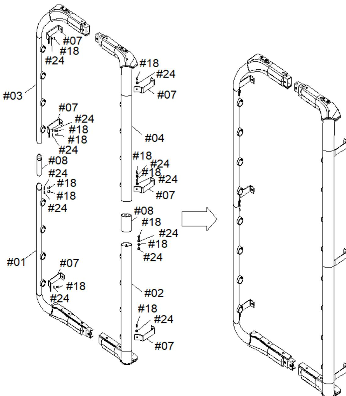
Na spodní rám (01) připevněte spojovací rám (08) pomocí šroubů (18), podložek (24) a klíče (28).
