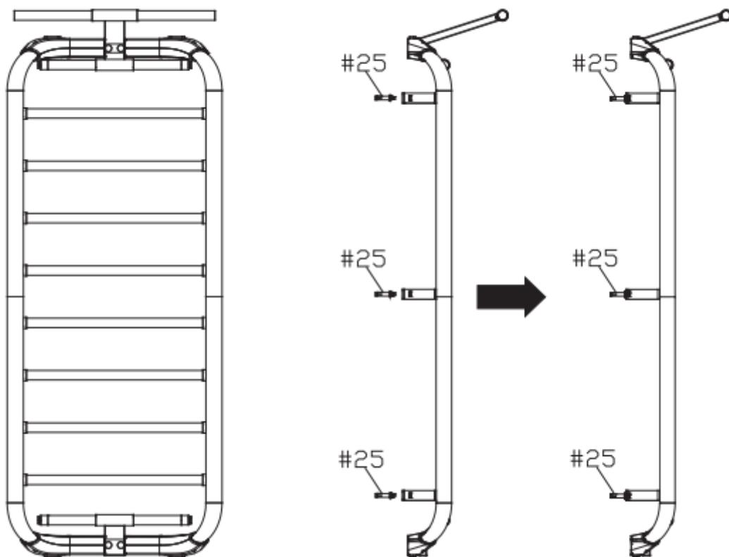
Žebřiny připevněte do předpřipravených otvorů do stěny pomocí hmoždinky a rozpínacích šroubů (M8\*80 mm).
