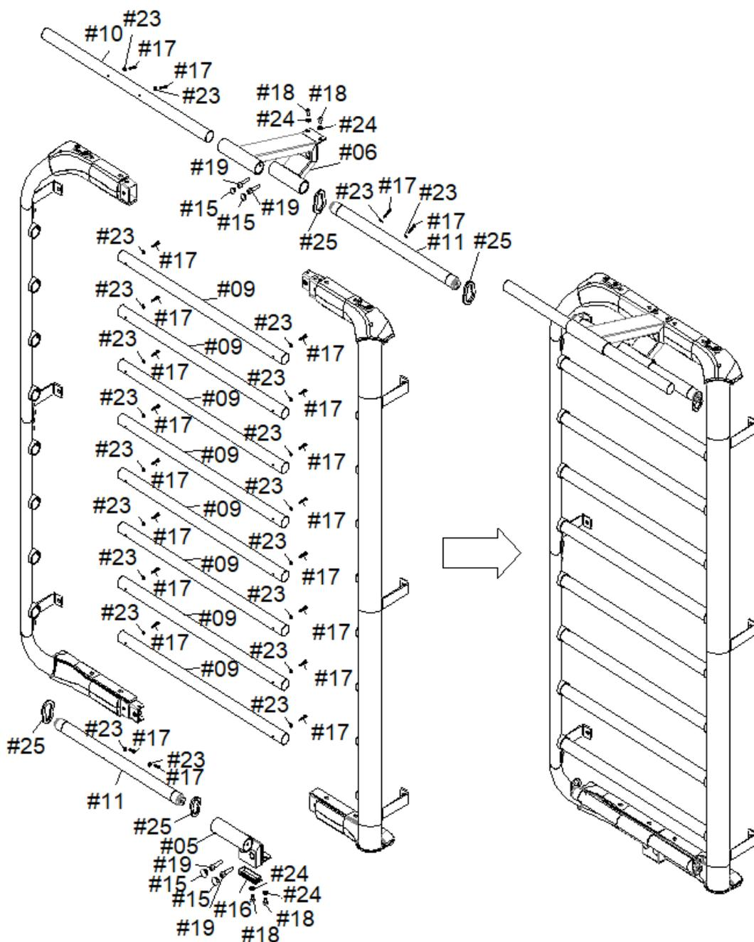
Připevněte příčku (11) do držáku nášlapu (05) pomocí šroubů (17), podložek (23) a krytky (16).
